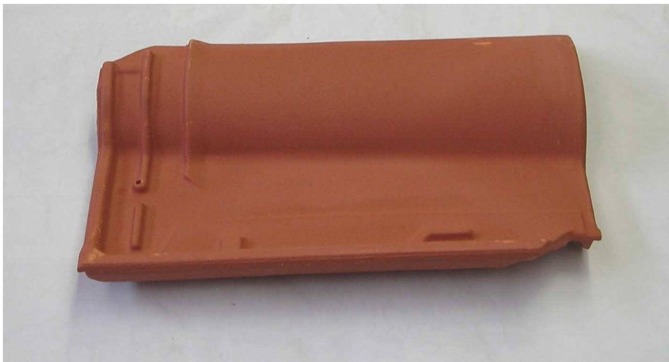
Figura 1. Riproduzione fotografica di un provino tal quale del prodotto "Tegola Portoghese Rossa".
