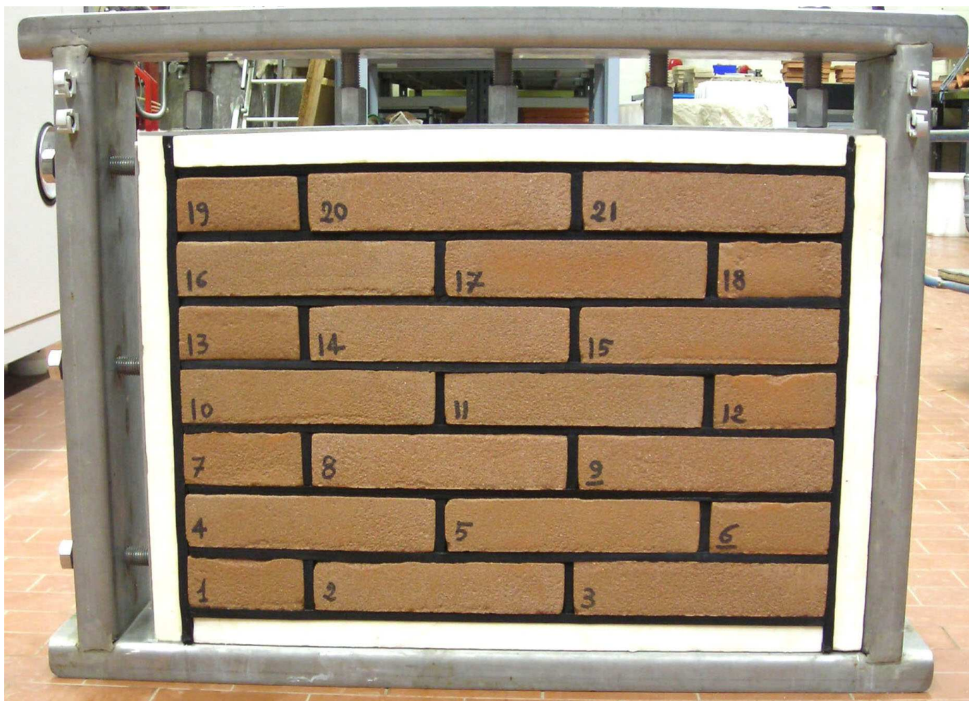
Figura 2. Riproduzione fotografica del pannello composto da 21 elementi (14 interi e 7 ricavati per taglio ad umido da campioni interi) del prodotto “Mattone Rosato” prima dell’effettuazione della prova di resistenza al gelo/disgelo. Sono visibili il telaio di acciaio inossidabile, i giunti di separazione di gomma e le quattro lastre laterali di polistirene estruso.
