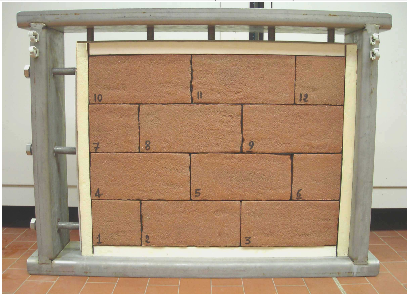
Figura 2. Riproduzione fotografica del pannello composto da 12 elementi (8 interi e 4 ricavati per taglio ad umido da campioni interi) del prodotto "XXXXXX" prima dell'effettuazione della prova di resistenza al gelo/disgelo. Sono visibili il telaio di acciaio inossidabile, i giunti di separazione di gomma e le quattro lastre laterali di polistirene estruso.
