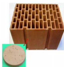
Determinazione della conducibilità termica base ed equivalente (UNI EN 1745)
